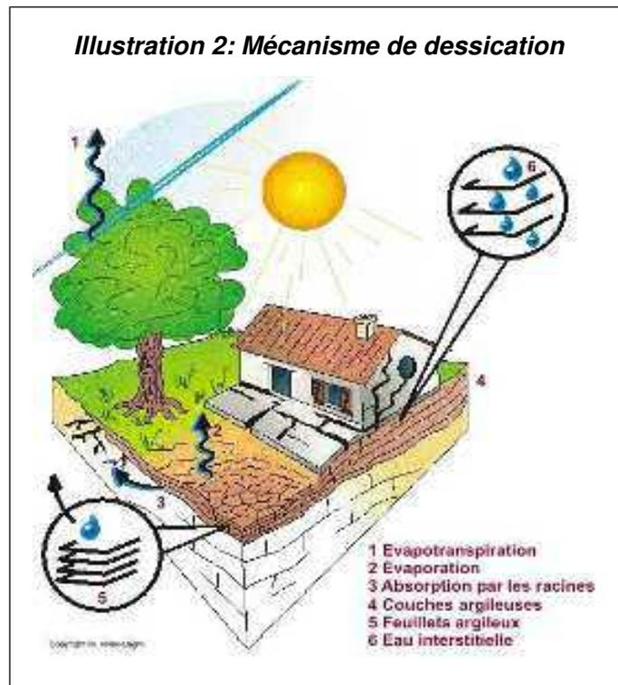
Retrait et gonflement sont deux mécanismes liés. Il arrive que leurs effets se compensent (des fissures apparues en été se referment parfois en hiver), mais la variabilité des propriétés mécaniques des sols de fondations et l'hétérogénéité des structures (et des régimes de contraintes) font que les phénomènes sont rarement complètement réversibles.
